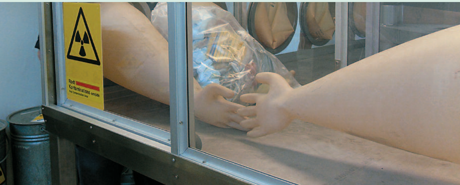
Pakning af driftsaffald i handskeboks.
